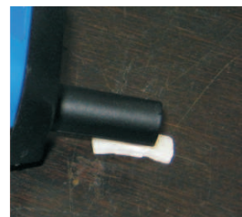
Figuras 5,6- Rugosímetro (aparelho utilizado para a leitura do desgaste produzido sobre a superfície do esmalte, após a escovação simulada. Figura. 5); a ponta ativa de diamante aplicada sobre o espécime (Figura. 6).
