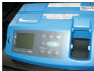
Figuras 5,6- Rugosímetro (aparelho utilizado para a leitura do desgaste produzido sobre a superfície do esmalte, após a escovação simulada. Figura. 5); a ponta ativa de diamante aplicada sobre o espécime (Figura. 6).
