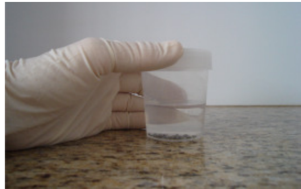
Figura 6 – Armazenamento de resíduos de amálgama em frascos de plástico rígido com tampa e boa vedação.
