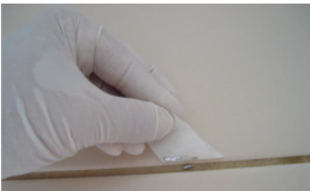
Figura 4 - Pequenas quantidades de mercúrio derramadas devem ser recolhidas imediatamente com fita crepe.
