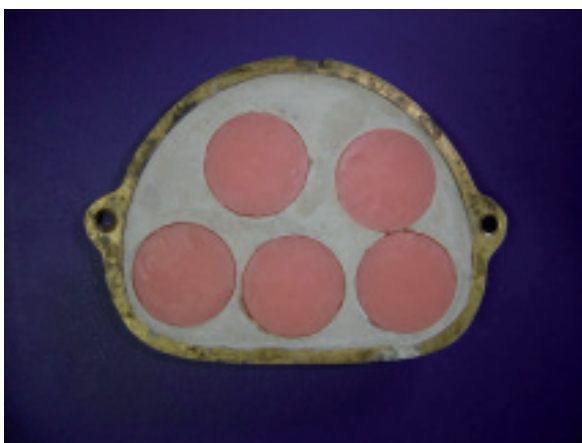
FIGURA 4 - Matriz de silicóna adaptada à disco de resina acrílica termoativada
