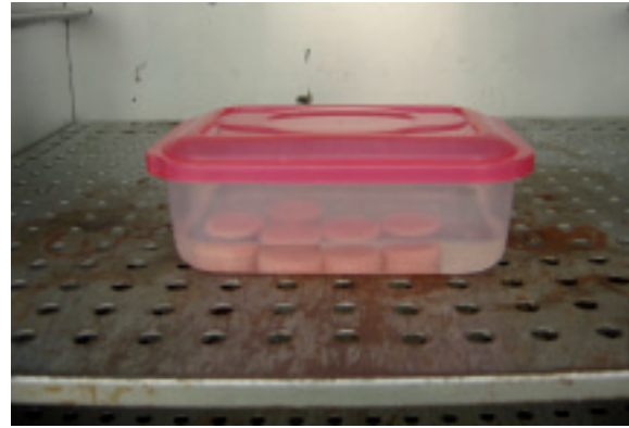
FIGURA 9 - Espécimes estocados em saliva artificial a 37 \pm 1^\circ\text{C}
