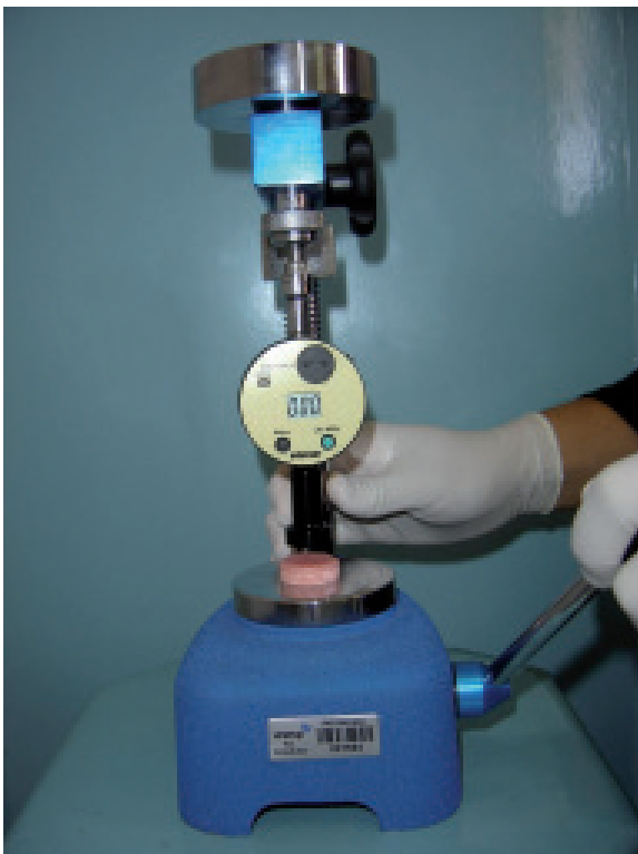
FIGURA 8 - Espécime em posição para leitura de dureza Shore A
