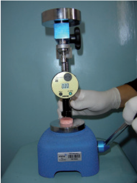
FIGURA 7 - Espécime em posição para leitura em rugosímetro digital
