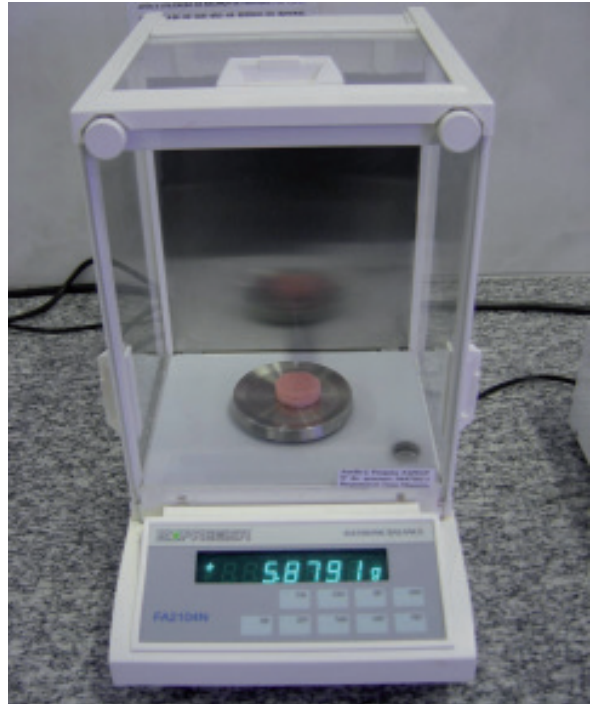
FIGURA 6 - Espécime sendo pesado em balança analítica
