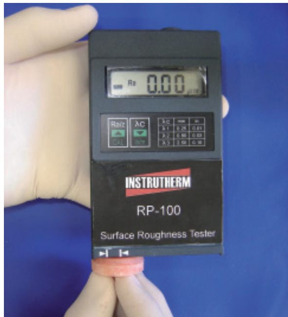
FIGURA 7 - Espécime em posição para leitura em rugosímetro digital
