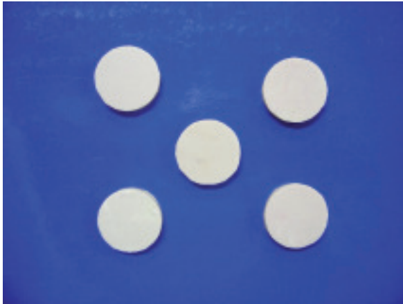
FIGURA 1 - Matrizes confeccionadas em silicóna laboratorial de condensação
